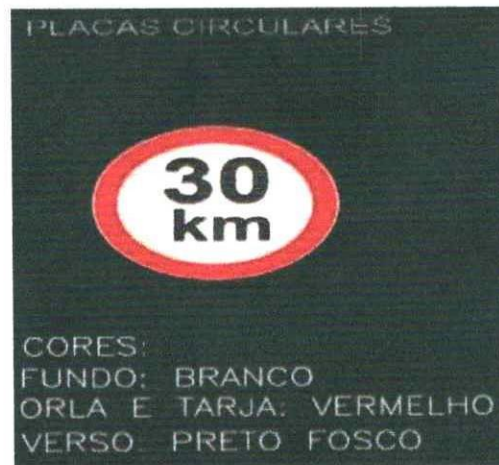
Figura 2. Placa de velocidade, com diâmetro de 60 cm.
