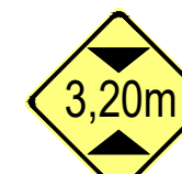
A-37 ALTURA LIMITADA
