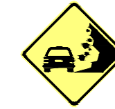
A-27 ÁREA COM DESMORONAMENTO
