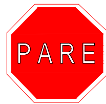
R1 DIMENSÕES: ORLA INTERNA = 0,02m ORLA EXTERNA = 0,02m LADO = 0,35m CORES: FUNDO = VERMELHA LETRAS = BRANCA ORLA INTERNA = BRANCA
